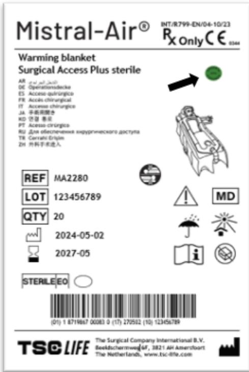
Étiquette avec autocollant indicateur OE vert. Ce produit a été stérilisé et peut être utilisé.
