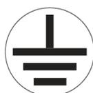
Branchez le système uniquement sur une prise murale mise à la terre. Un risque de décharge électrique existe lorsque l'équipement n'est pas branché sur une prise mise à la terre.
