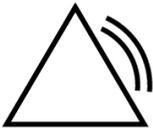
Anzeige eines Alarms mittlerer Priorität auf Steuerung
