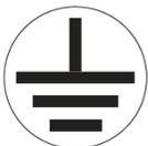
Das System nur mit einer geerdeten Wandsteckdose verbinden. Wird das Gerät nicht an eine ordnungsgemäß geerdete Netzsteckdose angeschlossen, besteht die Gefahr eines Stromschlags.
