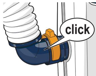
7. Sicherstellen, dass das Verbindungsstück vollständig eingeführt ist.
