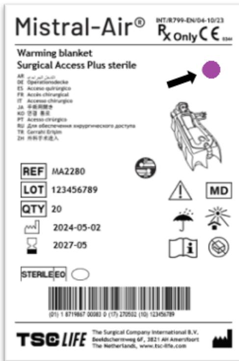
Etikett mit violetter EO-Indikator-Aufkleber. Dieses Produkt wurde nicht sterilisiert und darf nicht verwendet werden.
