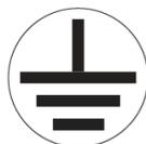
Brancher l'appareil uniquement sur une prise murale mise à la terre. Le risque de décharge électrique existe lorsque l'équipement n'est pas branché sur une prise mise à la terre.
