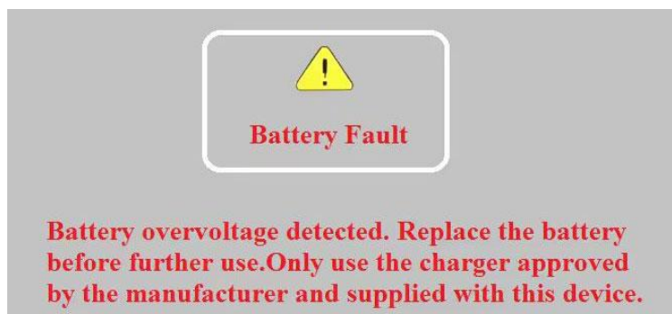
Fig. 17 – Avertissement de batterie surchargée
