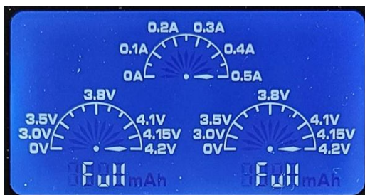
Fig. 7 – Indicateur de charge
