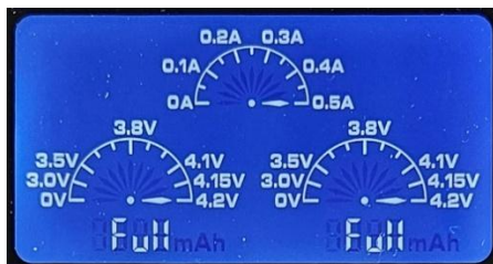
Fig. 12 – Indicateur de charge
