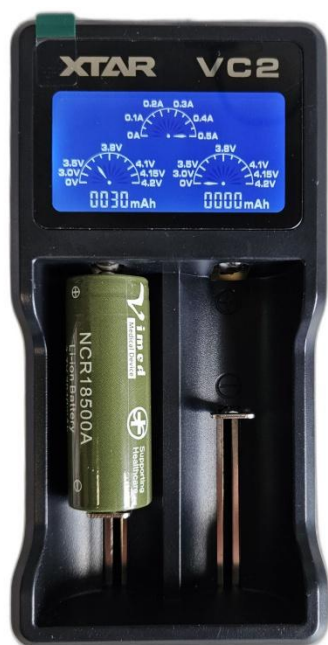
Fig. 6 – Chargement d'une seule batterie
